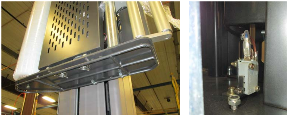
Figura 4 - 7 Interruptor de límite de detección de obstáculos
