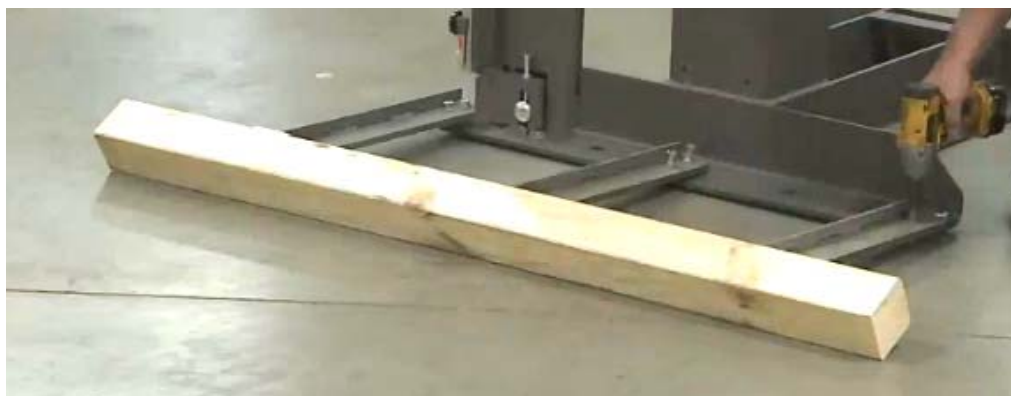
Figura 1 - 5 Retire las Patas de Transporte
