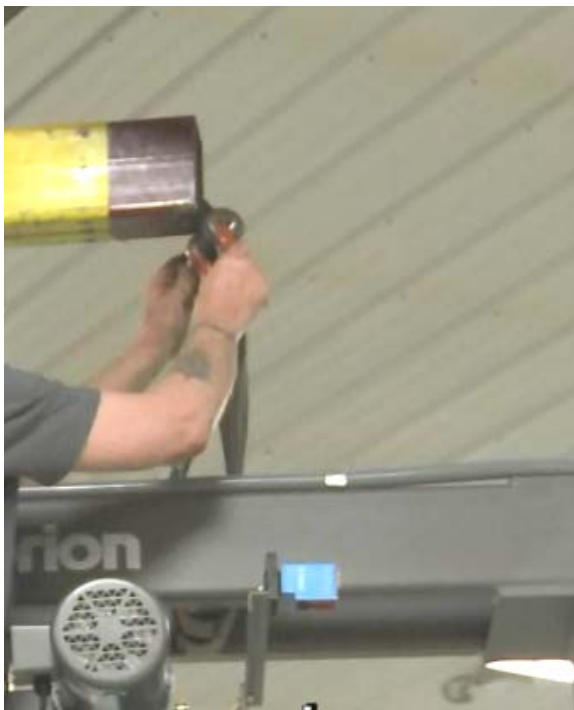
Figura 1 - 9 Retira el Acoplamiento
