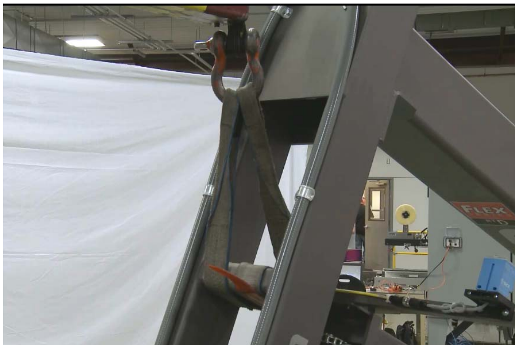
Figura 1 - 2 Colocando la Correa
