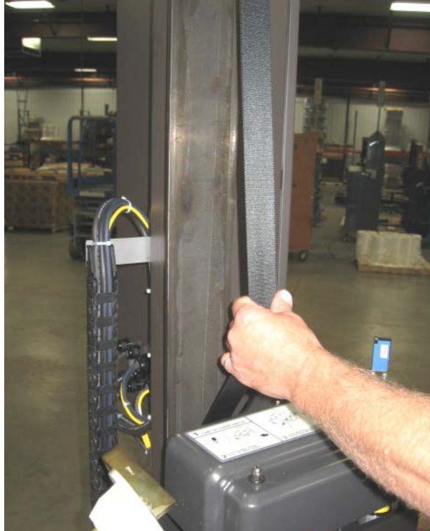
Figura 3 - 1 Jalando la Correa para Liberar el Freno
