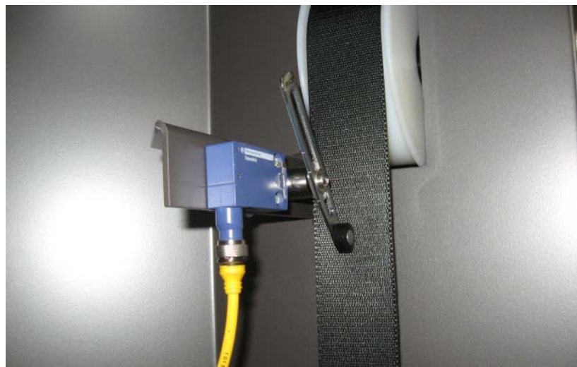
Figura 3 - 2 Interruptor de Límite Alineación
