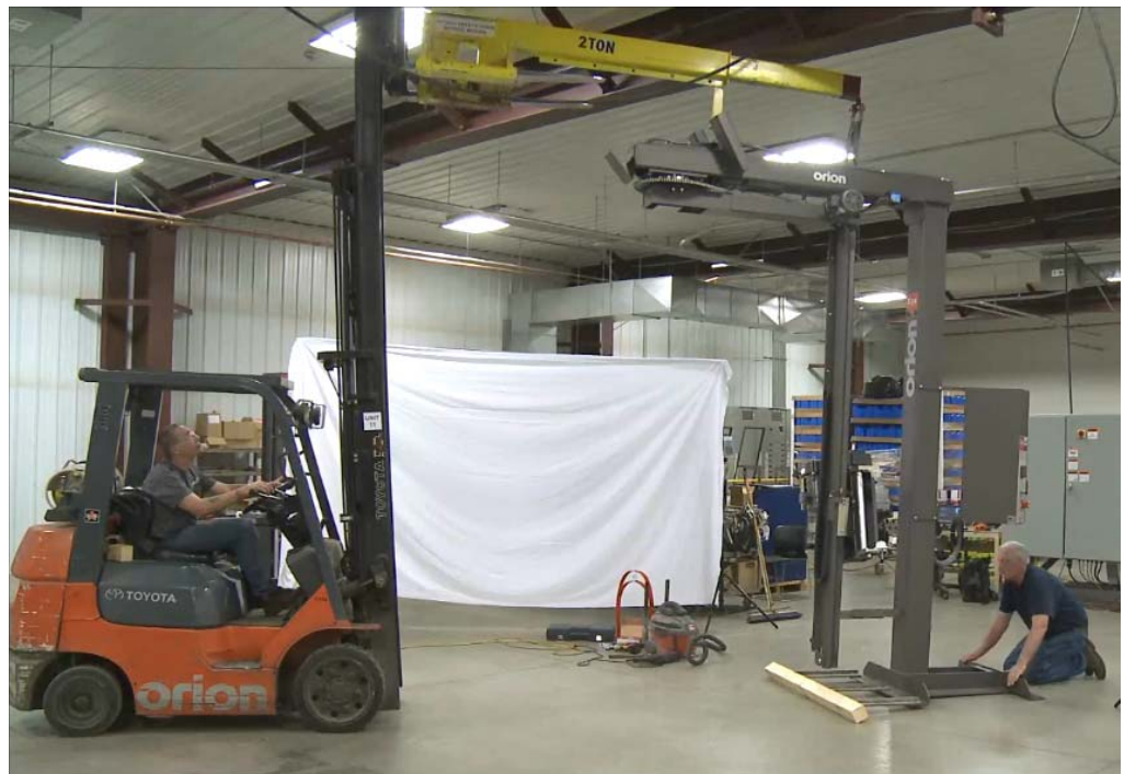
Figura 1 - 4 Posicionamiento de la Envolvedora
