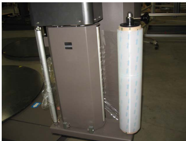
Figura 3 - 5 Película debidamente instalada
