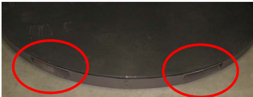
Figura 1 - 3 Tubos de horquilla para la elevación de la máquina
